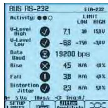
Le mode de test d'état des bus permet d'analyser la qualité du signal sur un réseau industriel.
