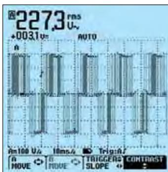
Le mode "Connect-and-View" permet de capturer sans aucun réglage les signaux de commande moteur les plus complexes.
