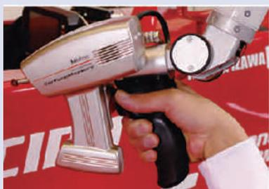
Capteur laser SurfaceMeasure
