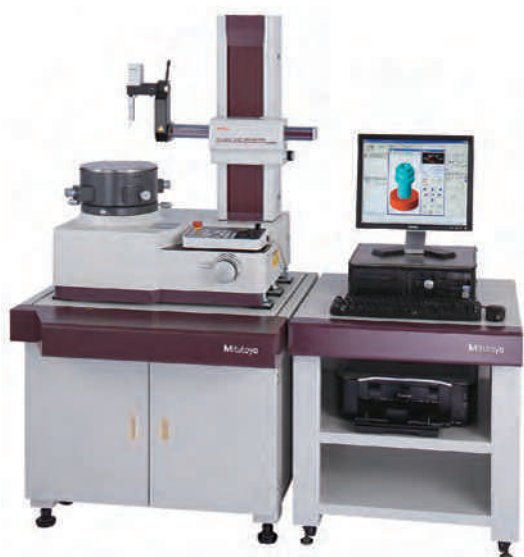
RA-2200 CNC + table anti-vibrations avec meuble informatique
