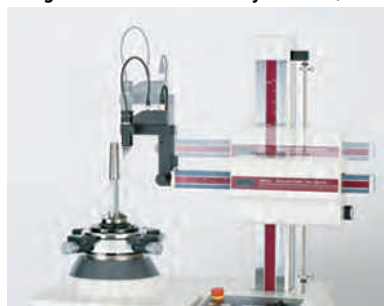
Suivi auto sur l'axe X pour rester au centre de la plage de mesure
